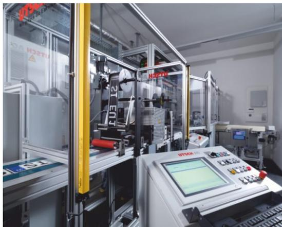
Dependiendo del grado de automatización, se puede realizar, por ejemplo, una salida de 400 pares de placas (800 piezas) en una sola hora y bajo supervisión de un único operador.
